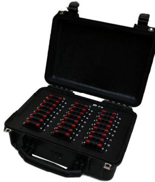
Das ptx system ist ein bidirektionales System. Mit einem ptx Controller können alle Ausgänge programmiert, getestet und gezündet werden (s. Bedienungsanleitungen ptx Controller).
