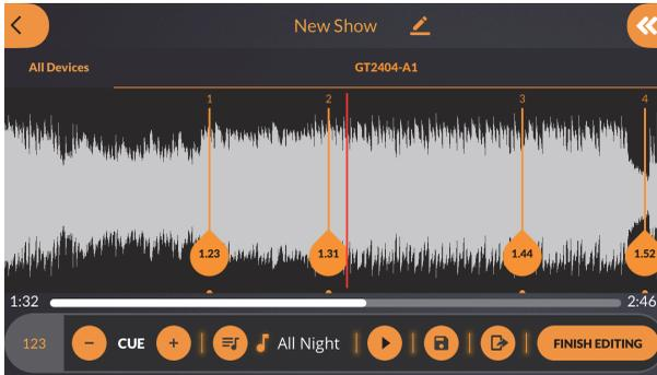
6. Verschieben Sie das Fähnchen bei Bedarf zum vorgesehenen Zeitpunkt, an dem der Kanal gezündet werden soll. Die Fähnchen zeigen oben den Kanal und unten den Zündzeitpunkt an. Der Mindestabstand zwischen zwei Zündpunkten beträgt 2 Sekunden.
