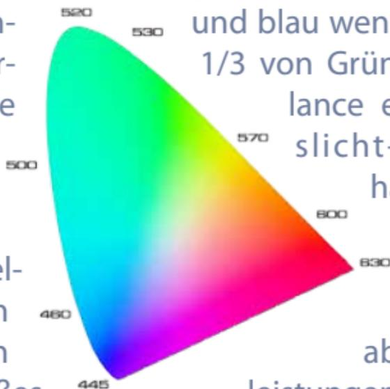
verschiedene Wellenlängen unterschiedlich hell wahr: grün ist sehr gut sichtbar, rot und blau weniger gut (nur ca. 1/3 von Grün). Die Weißbalance eines RGB-Weisslicht-Lasersystems hängt von der Leistung der einzelnen Laserquellen ab. Deren Einzelleistungen geben für die jeweilige Farbtemperatur der Mischung den Ausschlag.
