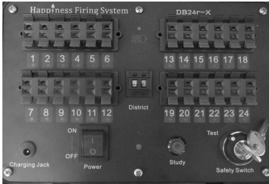
a) Schalten Sie den Sender und die Empfänger am "Power" Schalter an. Wenn die Batterieanzeige (jeweils über dem Batteriesymbol siehe Bild unten) blinkt, sollten Sie das jeweilige Gerät laden.
